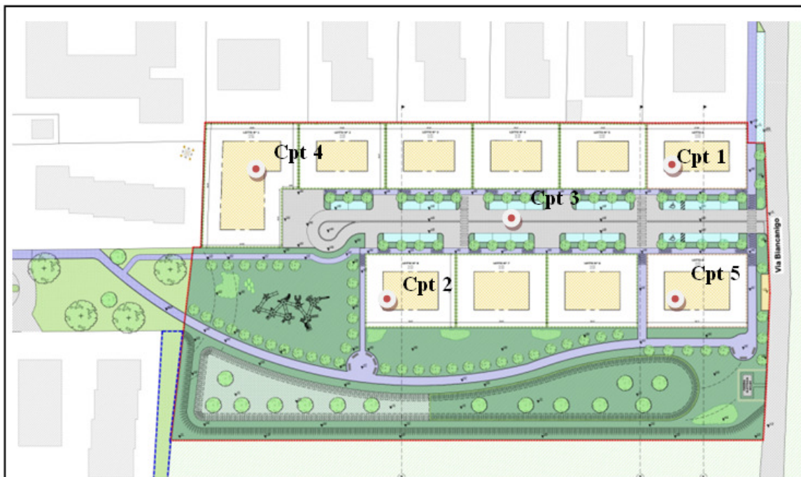
Fig. 16 – Ubicazione prove verticali CPT eseguite nell'area in oggetto
